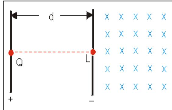
Die ganze Anordnung befindet sich im Vakuum. Die Protonen erfahren im homogenen elektrischen Feld des Kondensators die Kraft  $F = 8,0 \cdot 10^{-15} \text{ N}$ .
