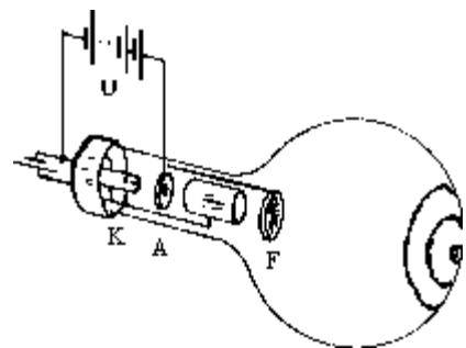
Gemessen werden für eine Beschleunigungsspannung U bei gegebenem Graphit-Schirm-Abstand l die Radien r der Beugungsringe.
